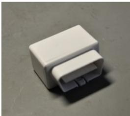
Um die Funktion OBD Live Data nutzen zu können, muss vor dem Start von „OBD Live Data“ der OBD Dongle Stecker in die OBD-Buchse gesteckt werden. Dieser muss wieder entfernt werden, bevor ein anderes Diagnosesystem an das Fahrzeug angeschlossen wird. Verwenden Sie die Funktion „OBD Live Data“ niemals gleichzeitig mit einem anderen Diagnosesystem.
