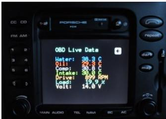
Das System PNU bietet zusätzlich zu der neuen Navigation auch die Möglichkeit Fahrzeugmesswerte in Echtzeit dazustellen, die normalerweise nur mit einem speziellen Diagnosesystemen möglich ist. Diese Funktion wurde für Rennsportfans entwickelt. Die Funktion kann im Menü „PNU Settings“ (Aktivierung siehe Punkt 3) gestartet werden. Angezeigt werden diverse Betriebstemperaturen, die Drehzahl und die Bordspannung. Die Daten stamme allesamt direkt aus dem Motorsteuergerät.
